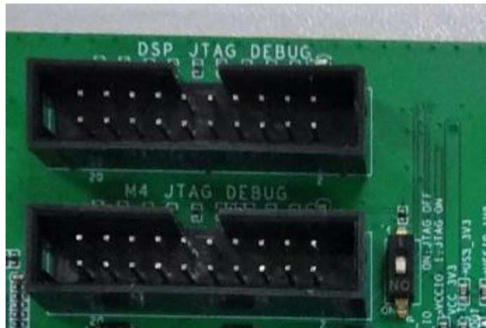
图3-12 M4 JTAG接口电路
