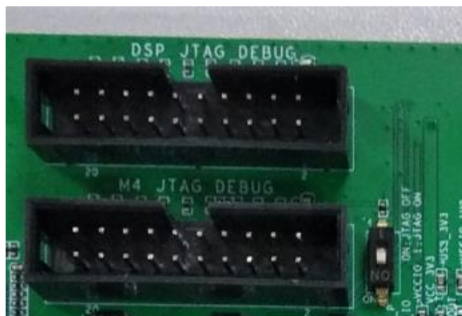
图3-13 DSP JTAG接口电路
